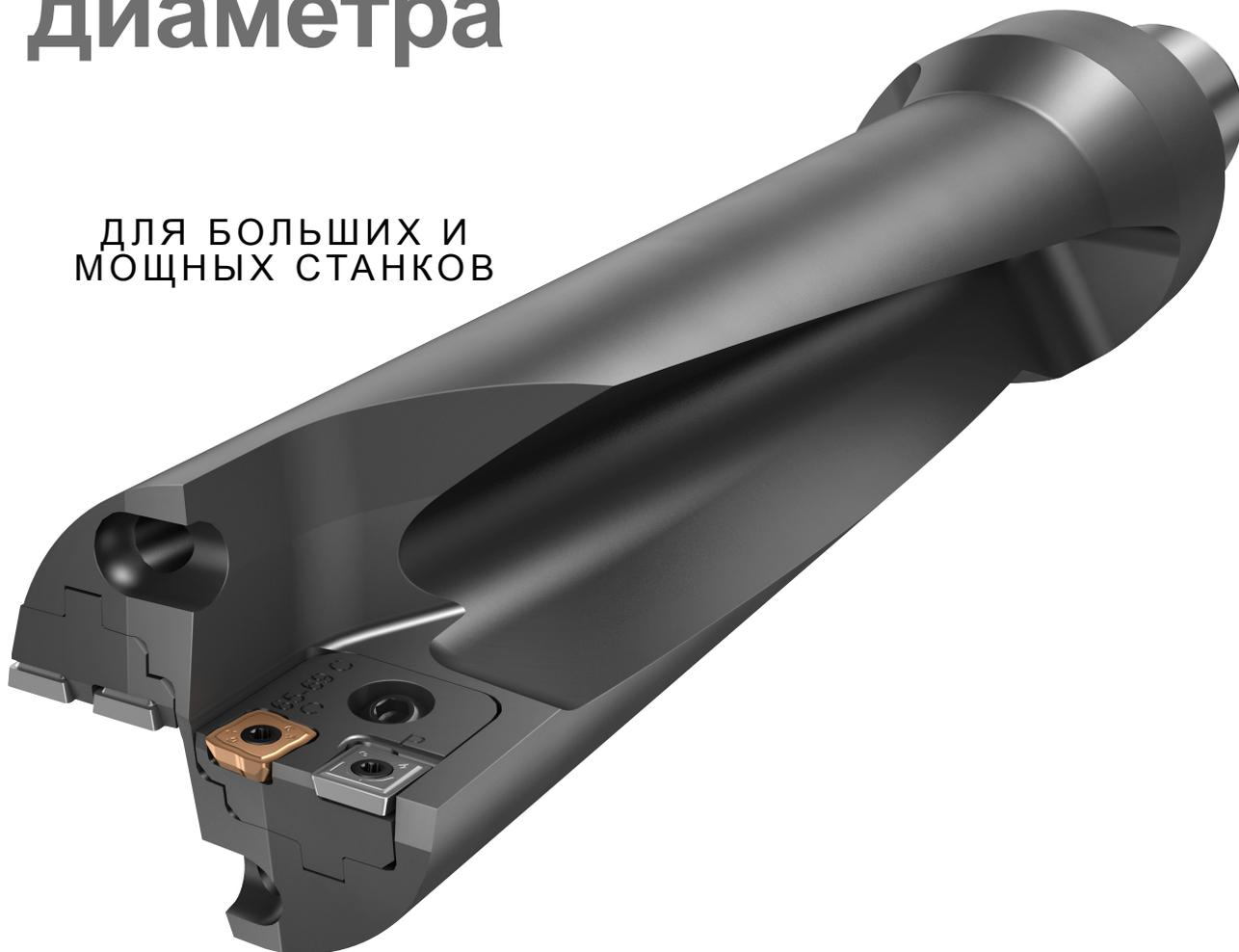
Сверло CoroDrill 880 разработано для надежного и безопасного сверления отверстий большого диаметра. Прочный корпус сверла оснащен кассетами для упрощения настройки диаметра. Это позволяет использовать один корпус сверла для обработки различных диаметральных размеров отверстий в диапазоне 5 мм (0,197").
