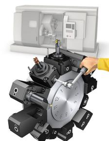
Токарные центры с приводными инструментальными блоками
