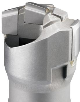
При обработке материалов с затрудненным стружкодроблением или неоднородной структурой выбирайте CoroDrill 808 для обеспечения хорошей работоспособности. Эта сверлильная головка имеет две геометрии режущих пластин для широкого диапазона возможных режимов резания и обеспечивает превосходное стружкодробление. Являясь первым выбором для выполнения отверстий с жёсткими допусками, она прекрасно подходит для энергетической промышленности, например, для обработки пластин теплообменников.
